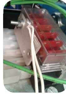
1 resistência de 5W para cada caixa de fusível
