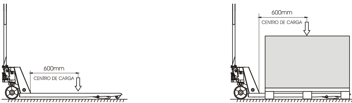
Figura 1 - Centro de Carga
